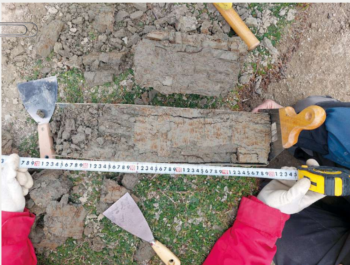
FIGURA 5. Detalle de un muestreador metálico con tramo sedimentario de la sección AG.
