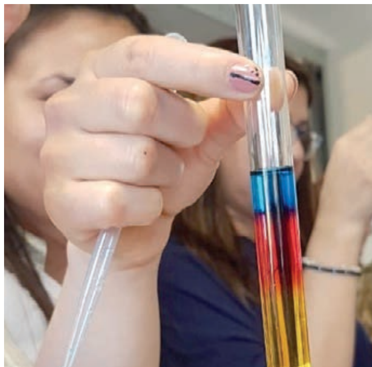
Figura: Tubo de ensayo con soluciones de colores ordenadas en capas según su densidad.
